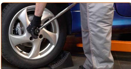
Substituição: pastilhas de travão – PEUGEOT 206 Hatchback (2A/C).
