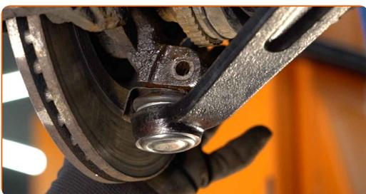
**62** Instale o parafuso de fixação.
