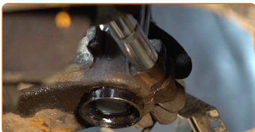
**57** Aperte o suporte de fixação da mangueira do travão do amortecedor. Use uma chave soquete nº 13. Use uma chave de catraca.
