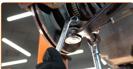
**65** Aperte os fixadores inferiores que conectam a coluna de suspensão à manga de eixo. Use uma chave soquete nº 18. Use uma chave de torque. Aperte-o para o torque de 55 Nm.
