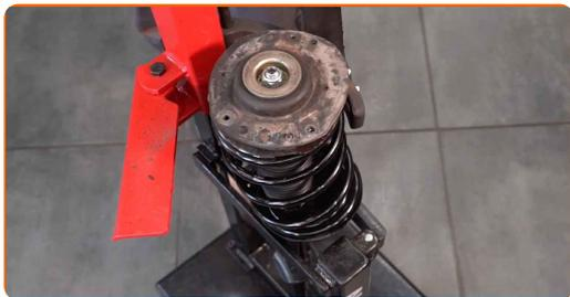
**50** Retire a coluna de suspensão montada.
