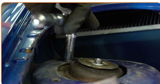
**53** Trate o assento de montagem da coluna de suspensão na manga de eixo. Use uma escova metálica. Use spray WD-40.
