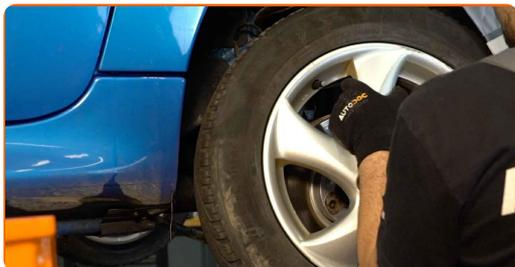
**11** Solte o elemento fixador que liga a junta esférica do braço de suspensão à manga do eixo. Use uma escova metálica.
