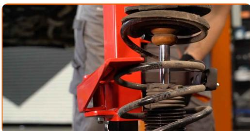
**37** Trate a haste da coluna do amortecedor. Use uma escova metálica. Use spray WD-40.
