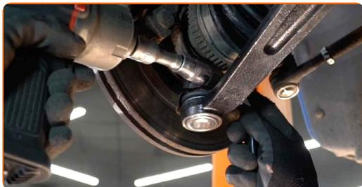
**64** Aperte o fixador da articulação esférica. Use uma chave soquete nº 17. Use uma chave combinada nº 17. Use uma chave de torque. Aperte-o para o torque de 40 Nm.
