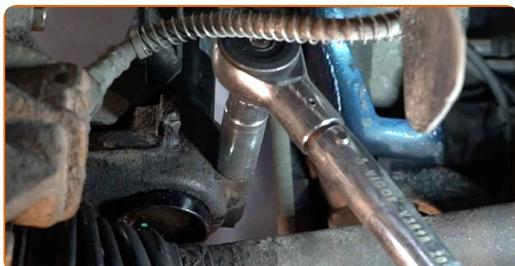
**66** Instale o terminal do estabilizador transversal. Use uma chave soquete nº 16.
