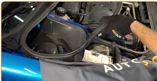
4 Remova a tampa do apoio da coluna de suspensão.
