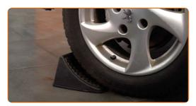
Solte os parafusos de montagem das rodas. Use o soquete de impacto para roda #19.
