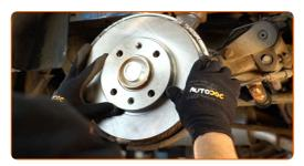
Aperte a fixação do disco de travão. Use Torx T30. Use uma chave de torque. Aperte-o para o torque de 9 Nm.
