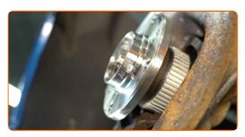
Aperte o cubo. Use uma chave soquete nº 32. Use uma chave de torque. Aperte-o para o torque de 230 Nm.
