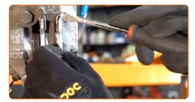
Remova o pino de retenção da pastilha de travão. Use alicates de ponta arredondada.
