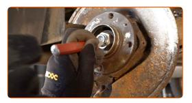
Desaperte a porca do eixo do cubo da roda. Use uma chave soquete nº 32. Use uma chave de tarraxa.
