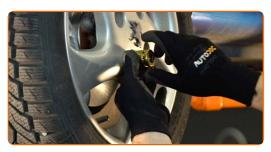
Baixar o carro e trabalhar em ordem transversal, apertar os parafusos das rodas. Use uma chave de torque. Aperte-o para o torque de 100 Nm.
