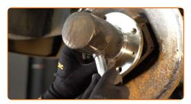
Limpe o cubo. Use uma escova metálica. Trate a superfície de contacto. Use massa de cobre.
