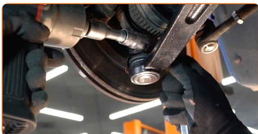
**34** Aperte o fixador frontal, conectando o braço de controlo à subestrutura. Use uma chave soquete nº 21. Use uma chave de torque. Aperte-o para o torque de 111 Nm.
