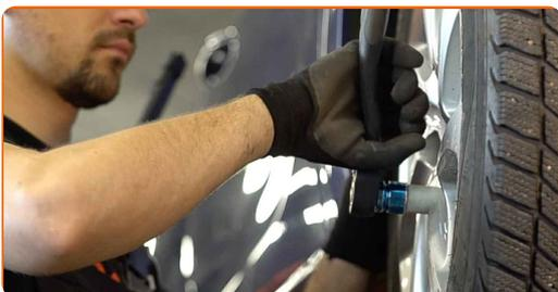
**34** Baixar o carro e trabalhar em ordem transversal, apertar os parafusos das rodas. Use uma chave de torque. Aperte-o para o torque de 100 Nm.
