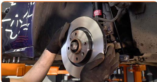
**22** Aperte a fixação do disco de travão. Use Torx T30. Use uma chave de torque. Aperte-o para o torque de 9 Nm.
