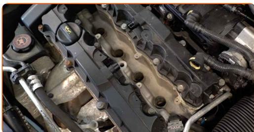
**13** Aplique uma camada fina de um lubrificante antigripante de alta temperatura específico às roscas das novas velas de ignição.
