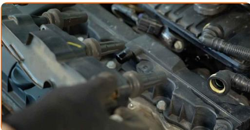
**10** Limpe a sujidade, poeira e detritos de dentro dos poços das velas de ignição.
