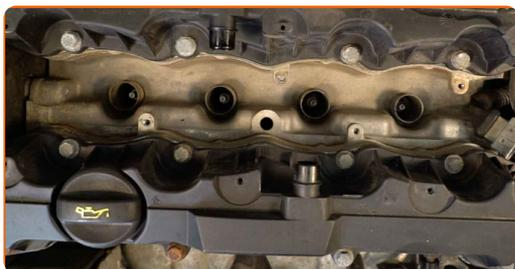
**11** Desaperte as velas de ignição. Use o soquete da vela de ignição #16. Use uma chave de catraca.
