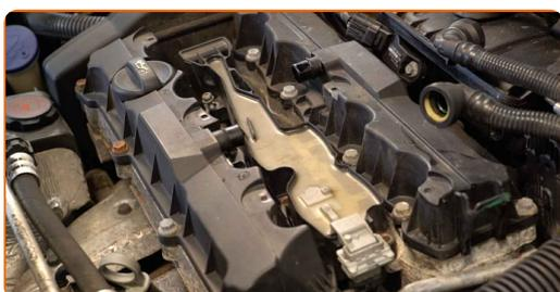
**19** Aperte os fixadores das bobinas de ignição. Use Torx T20. Use uma chave de torque. Aperte-o para o torque de 8 Nm.
