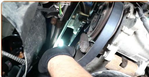
Substituição: correia trapezoidal estriada – PEUGEOT 206 SW (2E/K).
