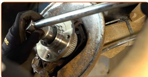
Substituição: rolamento da roda – PEUGEOT 206 Van. Conselho:
