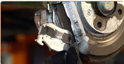
**11** Limpe os elementos de fixação da pinça de travão. Use uma escova metálica. Use spray WD-40.
