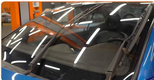
**2** Desligue a ignição. No modo de serviço, os limpa para-brisas estarão na posição superior.
