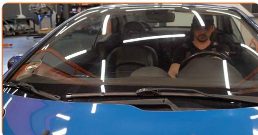
**8** Ligue a ignição. Volte a pôr os limpa-para-brisas na posição de funcionamento.
