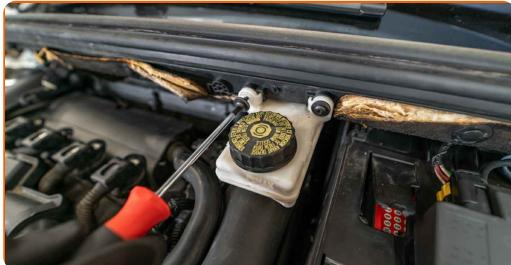
**4** Remova o reservatório do líquido de travões. Coloque-o de lado.
