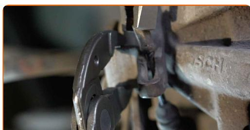
**9** Limpe os elementos de fixação da pinça de travão. Use uma escova metálica. Use o spray de limpeza universal.
