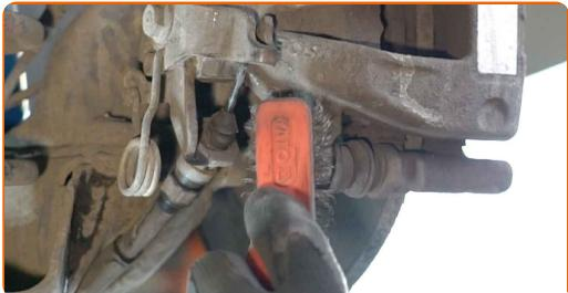
**10** Desaparafuse a fixação de pinça de travão. Use uma chave combinada nº 19. Use uma chave soquete nº 13. Use uma chave de catraca.
