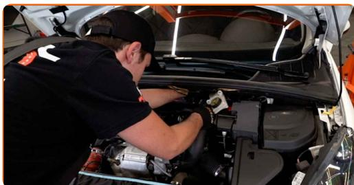
13 Aparafusar os parafusos de fixação da tampa do filtro de ar (3 peças). Use Torx T25. Use uma chave de catraca.
