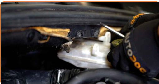
5 Desaperte a braçadeira e os fixadores no tubo de entrada de ar do filtro de ar. Use uma chave combinada nº 7.
