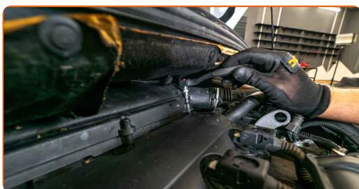
14 Conecte o tubo de entrada de ar ao compartimento do filtro de ar.
