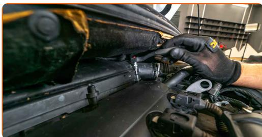
7 Desconecte o tubo de entrada de ar do compartimento do filtro de ar.
