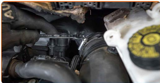
6 Desaperte os parafusos de fixação da tampa do filtro de ar (3 peças). Use Torx T25. Use uma chave de catraca.
