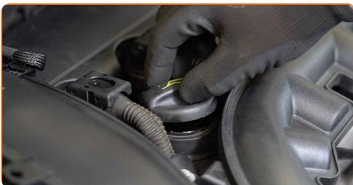
**36** Despeje o óleo no motor através do gargalo de enchimento de óleo. Quantidade necessária de óleo: 4.25 l.
