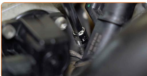
**33** Ligue a mangueira de ventilação do cárter ao tubo de ventilação.
