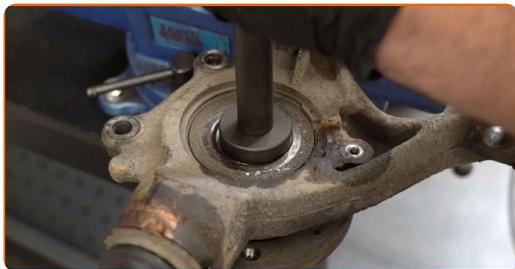
**36** Remova o anel interior do cubo de rolamento para fora do cubo da roda. Utilize um separador de rolamentos. Use uma saca-polia de três garras.
