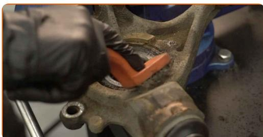
**38** Remova o anel de retenção do mancal do cubo de roda. Utilize o alicate de anilhas.
