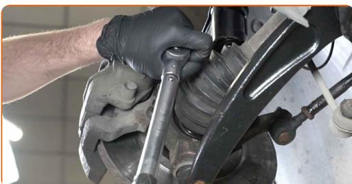
**59** Aperte os fixadores inferiores que conectam a coluna de suspensão à manga de eixo. Use uma chave combinada nº 18. Use uma chave soquete nº 18. Use uma chave de torque. Aperte-o para o torque de 90 Nm.
