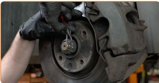
**8** Limpe os fixadores do eixo motor. Use uma escova metálica. Use spray WD-40.
