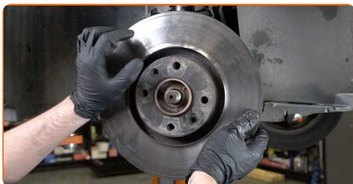
**56** Aperte a fixação do disco de travão. Use Torx T30. Use uma chave de torque. Aperte-o para o torque de 9 Nm.
