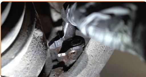
**32** Remova o parafuso de fixação.
