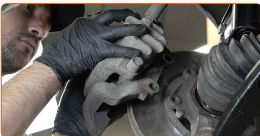
**58** Aperte a braçadeira da pinça do travão. Use Torx T50. Use uma chave de torque. Aperte-o para o torque de 105 Nm.
