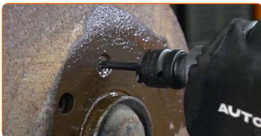
**8** Retire os parafusos de fixação.
