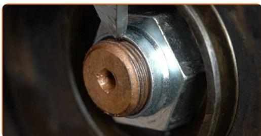
**80** Aplique produto no fixador da junta esférica. Aplique produto no fixador que liga a torre da suspensão à manga de eixo. Aplique produto no fixador que liga a biela da barra estabilizadora à torre de suspensão. Use massa de cobre.
