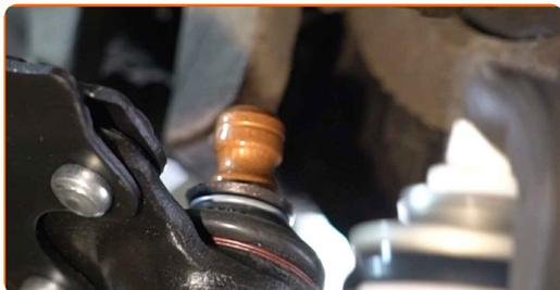
**66** Solte o elemento fixador que liga a junta esférica do braço de suspensão à manga do eixo. Use um cinzel plano para metal. Use um martelo.
