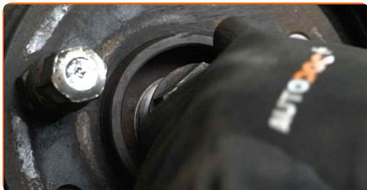
**78** Aperte a porca do eixo de transmissão. Use uma chave soquete nº 36. Use uma chave de torque. Aperte-o para o torque de 320 Nm.
