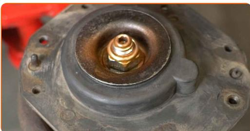
**55** Limpe os assentos de montagem da coluna do amortecedor. Use uma escova metálica. Use spray WD-40.
