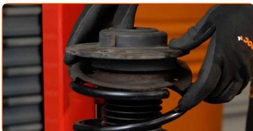
**52** Aperte a porca do suporte do amortecedor da haste do pistão. Chave para a porca do amortecedor de 22 mm. Use HEX n.º H6. Use uma chave de torque. Aperte-o para o torque de 50 Nm.
