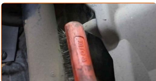
**11** Desaparafuse o fixador que conecta a bieleta da barra estabilizadora à coluna do amortecedor. Use uma chave soquete nº 17. Use uma chave de catraca.
