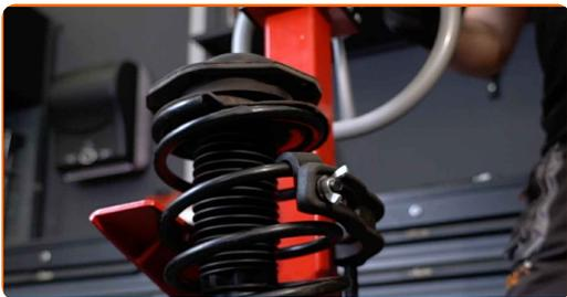
**54** Trate a haste da coluna do amortecedor. Use massa de cobre.
