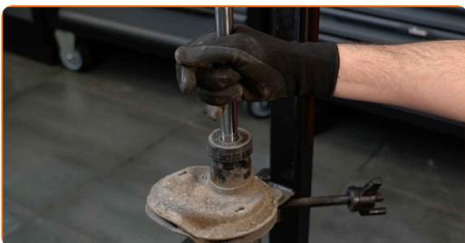
**47** Instale o amortecedor novo no compressor hidráulico de mola.
