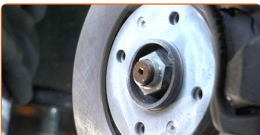
**83** Limpe a superfície do disco de travão. Utilize um produto de limpeza para travões.
