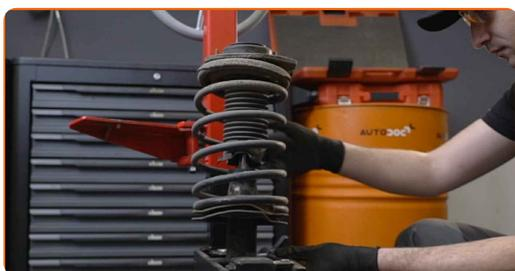
Substituição: kit de suspensão – PEUGEOT 306 Hatchback. AUTODOC recomenda:
