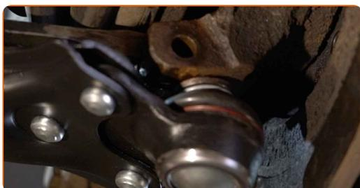
**68** Instale o parafuso de fixação.
