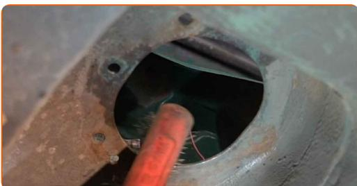
**56** Instale o amortecedor no arco da roda.
