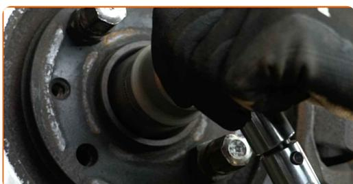
**79** Empurre o elemento de fixação do eixo de transmissão. Use um cinzel plano para metal. Use um martelo.
