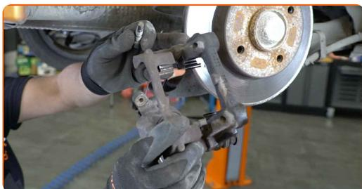
**17** Limpe os elementos de fixação do disco de travão. Use uma escova metálica. Use spray WD-40.
