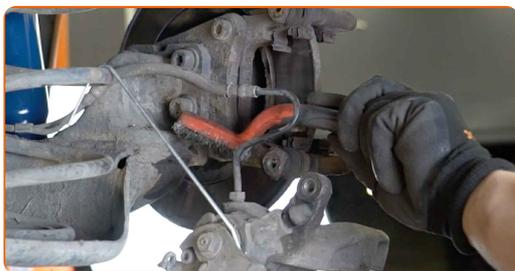
**15** Desaperte a fixação da braçadeira da pinça. Use Torx T55. Use uma chave de tarraxa.
