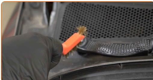
**4** Desaperte os fixadores dos braços do limpador vidros do para-brisa. Use uma chave soquete nº 16. Use uma chave de catraca.
