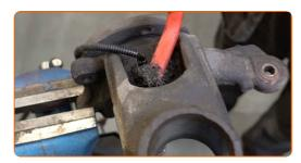
Desaparafuse o elemento fixador do sensor ABS. Use uma chave soquete nº 13. Use uma chave de catraca.
