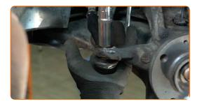
Aperte a porca de fixação conectada ao terminal de direção à manga de eixo. Use uma chave soquete nº 17. Use uma chave de torque. Aperte-o para o torque de 35 Nm.
