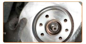
Desenrosque a extremidade da porca de fixação da manga de eixo. Use uma chave soquete nº 17. Use uma chave de catraca.
