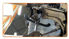
Instale o parafuso de fixação. 58
