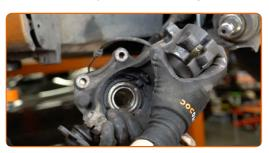
Coloque o mancal do eixo montado com o cubo de roda num torno.
