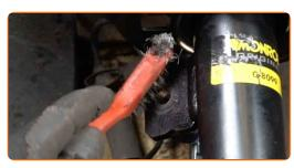
lnstale o terminal do estabilizador transversal.
