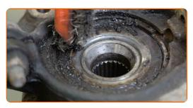
Remova o anel de retenção do mancal do cubo de roda. Utilize o alicate de anilhas.
