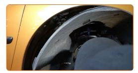
Volte a colocar os clipes de plástico do revestimento do arco da roda.
