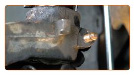
Aparafuse o fixador que conecta o amortecedor à manga de eixo. Use uma chave soquete nº 16. Use uma chave 59 de catraca.
