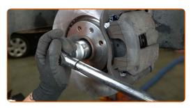
Trate o fixador do eixo CV. Use massa de cobre.
