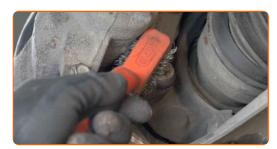
Desaperte a fixação da braçadeira da pinça. Use Torx T55. Use uma chave de tarraxa. Use uma chave de catraca. **17**
