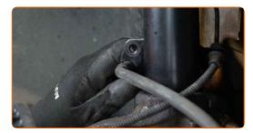
Aperte o suporte de fixação da mangueira do travão do amortecedor. Use uma chave soquete nº 13. Use uma chave de torque. Aperte-o para o torque de 10 Nm.
