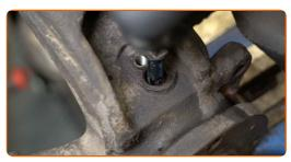
Aperte o fixador que liga o sensor de ABS ao manga de eixo. Use uma chave soquete nº 13. Use uma chave de torque. Aperte-o para o torque de 10 Nm.
