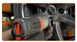
Baixar o carro e trabalhar em ordem transversal, apertar os parafusos das rodas. Use o soquete de impacto para roda #17. Use uma chave de torque. Aperte-o para o torque de 100 Nm.
