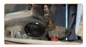
Desaparafuse o elemento de fixação inferior que liga a coluna de suspensão às mangas de eixo. Use uma chave soquete nº 16. Use uma chave de catraca.
