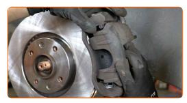
Aperte a braçadeira da pinça do travão. Use Torx T55. Use uma chave de torque. Aperte-o para o torque de 105 Nm.
