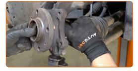
Desligar a manga de eixo do suporte do amortecedor. Use um martelo.
