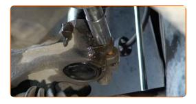
Remova o parafuso de fixação.
