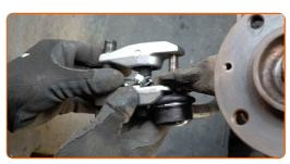
Limpe todas as juntas do braço. Use uma escova metálica. Use spray WD-40.
