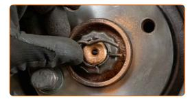
Trate todas as juntas de conexão do estabilizador. Trate todas as juntas do braço. Use massa de cobre.
