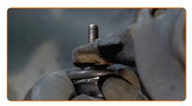
Aparafuse a porca de fixação que liga o terminal de direção à manga do eixo. Use uma chave soquete nº 17. Use uma chave de catraca.
