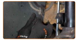
Limpe os assentos de montagem do terminal da direção. Use uma escova metálica. Use spray WD-40.
