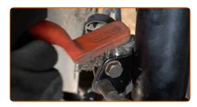
Desaperte o suporte de fixação da mangueira do travão do amortecedor. Use uma chave combinada nº 13.
