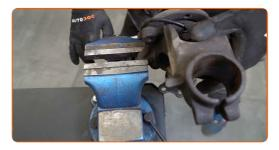
Limpe o assento de montagem do sensor de ABS. Use uma escova metálica. Use spray WD-40.
