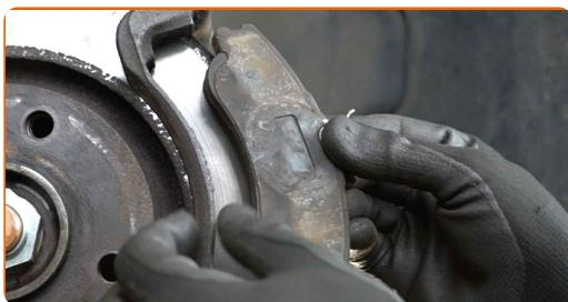
**Substituição: pastilhas de travão – PEUGEOT 307 Hatchback (3A/C).**
