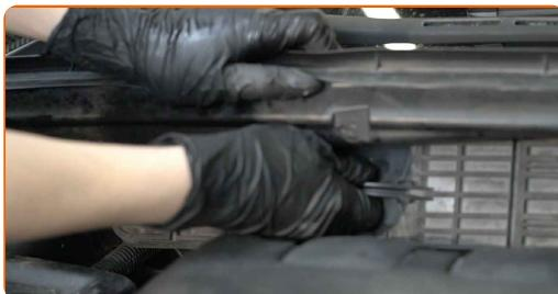
**4** Remova o elemento de filtro a partir da caixa do filtro.
