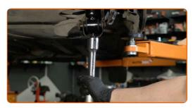
Aperte a fixação inferior do amortecedor. Use uma chave combinada nº 13. Use uma chave soquete nº 15. Use uma chave de torque. Aperte-o para o torque de 57 Nm.
