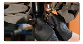
Apertar a fixação superior do amortecedor. Use uma chave soquete nº 13. Use uma chave de torque. Aperte-o para o torque de 45 Nm.
