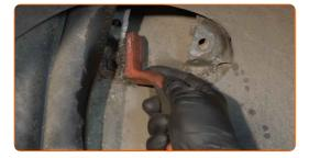
21 Trate os assentos de montagem do amortecedor. Use massa de cobre.
