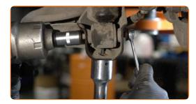
Desaperte a fixação superior do amortecedor. Use uma chave soquete nº 13. Use uma chave de catraca.
