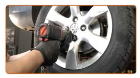
Baixar o carro e trabalhar em ordem transversal, apertar os parafusos das rodas. Use o soquete de impacto para 33 roda #17. Use uma chave de torque. Aperte-o para o torque de 100 Nm.
