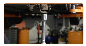
Desaperte a fixação inferior do amortecedor. Use uma chave combinada nº 13. Use uma chave soquete nº 15. Use uma chave de catraca.
