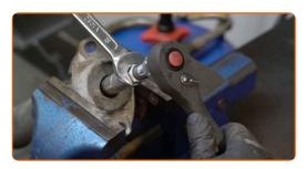
Remova o suporte do amortecedor, a coifa e o batente de encosto do amortecedor.
