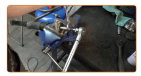
Trate do elemento fixador da haste do amortecedor. Use massa de cobre.
