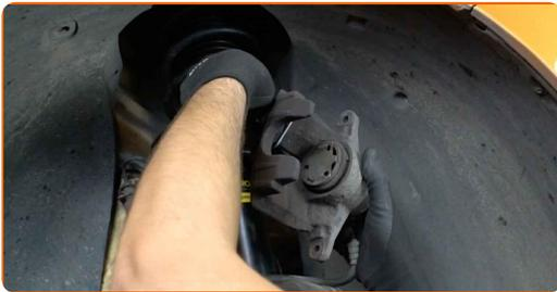
Substituição: discos de travão – PEUGEOT 308 SW I Van / Carrinha (4E\_).
