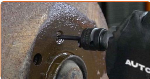
**8** Retire os parafusos de fixação.
