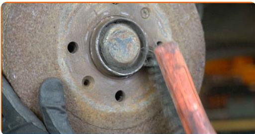
**7** Desenrosque os parafusos do tambor de travão. Use Torx T30. Use uma chave de fenda de impacto.
