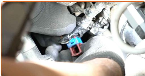
**4** Limpe o fixador do sensor de oxigénio. Use uma escova metálica. Use spray WD-40.
