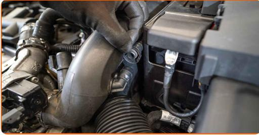
**34** Ligue o sensor de vácuo. Aperte a braçadeira com um alicate de combinação e conecte a mangueira da válvula de vácuo.
