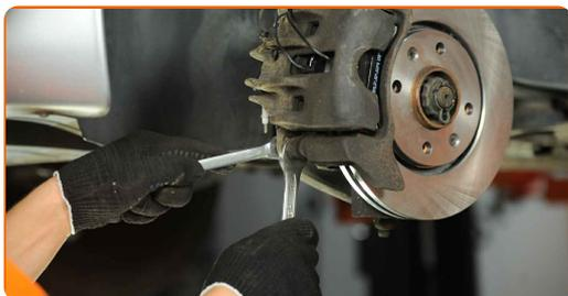
**23** Conecte o cabo do sensor de desgaste da pastilha do travão.
