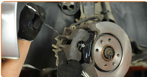
**21** Instale os parafusos de fixação (2 peças).
