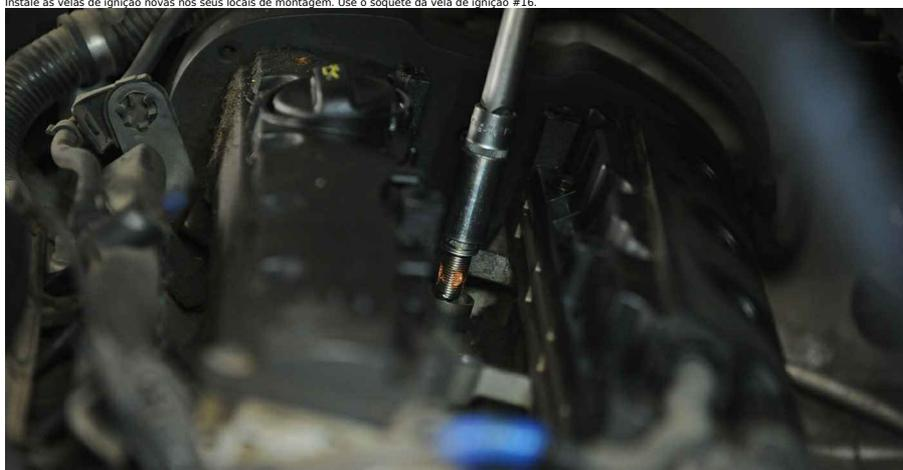
13 Aparafuse as novas velas de ignição e aperte-as. Use o soquete da vela de ignição #16. Use uma chave de torque. Aperte-o para o torque de 25 Nm.
