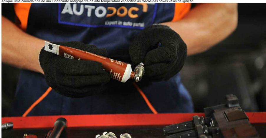
12 Instale as velas de ignição novas nos seus locais de montagem. Use o soquete da vela de ignição #16.
