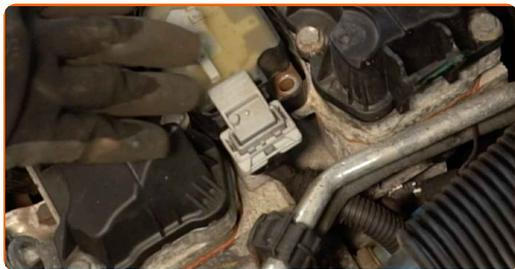
**18** Instale as bobinas de ignição nos poços das velas de ignição. Certifique-se que ouve um clique a indicar que está fixa no local.
