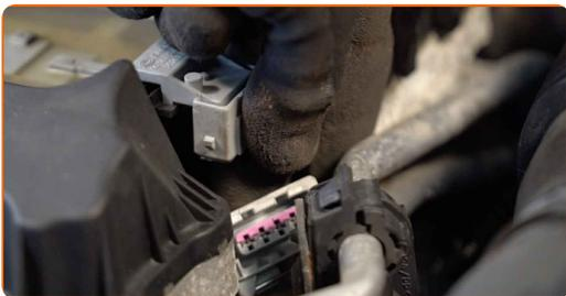
**7** Desaperte o suporte da bobina de ignição. Use Torx T27.
