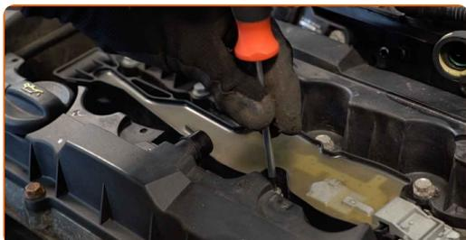
**20** Instale as mangueiras de ventilação do cárter.
