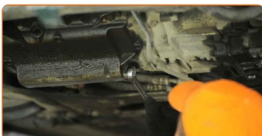
**17** Limpe a área do orifício de drenagem do cárter. Use o spray de limpeza universal.
