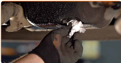
**16** Aparafuse o novo bujão de drenagem e aperte-o. Use uma chave combinada nº 22. Use uma chave de torque. Aperte-o para o torque de 30 Nm.
