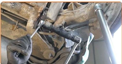
**10** Remova o parafuso de fixação.
