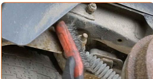
**8** Desaperte a fixação superior do amortecedor. Use uma chave soquete nº 24. Use uma chave de catraca.
