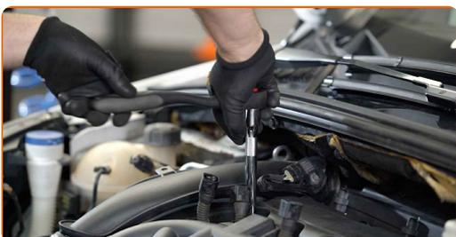
**Substituição: vela de ignição – PEUGEOT RCZ Coupe. Conselho da AUTODOC:**
