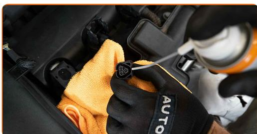
**13** Ligue os conectores das bobinas de ignição.
