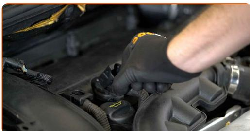
**4** Eleve a bobina de ignição. Utilize um pé-de-cabra. Retire a bobina de ignição do orifício da vela de ignição.
