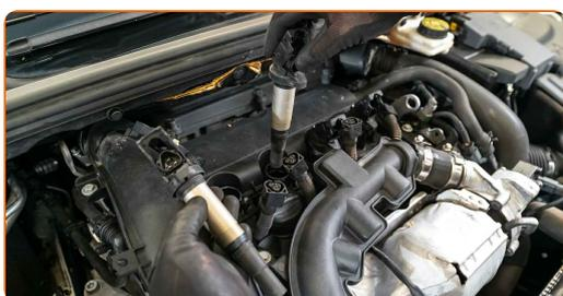
Substituição: vela de ignição – PEUGEOT RCZ Coupe. Conselho:
