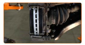
Instale a pinça do travão e fixe-o. Use uma chave soquete nº 12. Use uma chave de torque. Aperte-o para o torque de 30 Nm.
