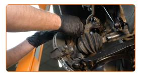
Aperte a braçadeira da pinça do travão. Use uma chave soquete nº 18. Use uma chave de torque. Aperte-o para o torque de 90 Nm.
