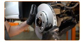
Aperte a fixação do disco de travão. Use Torx T30. Use uma chave de torque. Aperte-o para o torque de 4 Nm.
