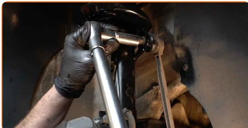
**66** Aperte a porca do eixo de transmissão. Use uma chave soquete nº 36. Use uma chave de torque. Aperte-o para o torque de 50 Nm.+45°
