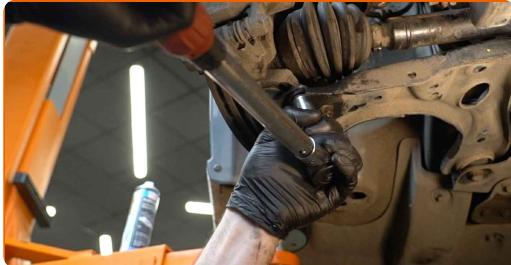
**65** Desaparafuse o fixador que conecta bieleta da barra estabilizadora à barra estabilizadora. Use uma chave soquete nº 16. Use uma chave de torque. Aperte-o para o torque de 40 Nm.
