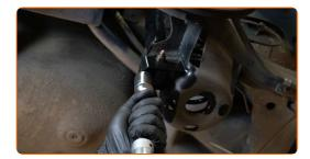
Aperte a fixação inferior do amortecedor. Use uma chave soquete nº 16. Use uma chave de torque. Aperte-o para o torque de 40 Nm.+90°
