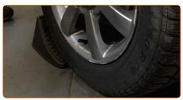
Solte os parafusos de montagem das rodas. Use o soquete de impacto para roda #17.
