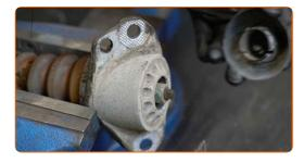
Limpe o elemento de fixação de componentes do amortecedor. Use uma escova metálica. Use spray WD-40.
