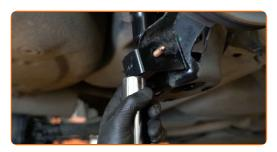
Instale o parafuso de fixação. Use uma chave combinada nº 16. Use uma chave soquete nº 16. Use uma chave de catraca.
