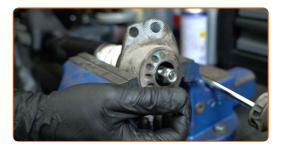
Aperte a fixação superior da haste do amortecedor. Utilize a chave para amortecedor DD№6. Use uma chave soquete nº 16. Use uma chave de torque. Aperte-o para o torque de 25 Nm.
