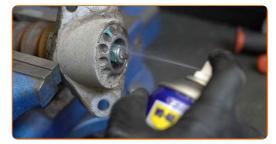
Retire a fixação da haste do pistão do amortecedor. Utilize a chave para amortecedor DDNº6. Use uma chave soquete nº 16. Use uma chave de catraca.
