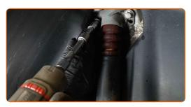
Remova o parafuso de fixação. Use uma chave soquete nº 16. Use uma chave de catraca.
