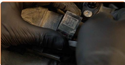
**6** Retire as bobinas de ignição dos poços das velas de ignição. Utilize um pé-de-cabra.
