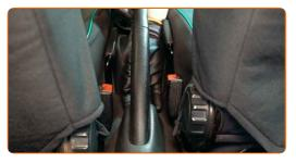
Desaperte o cabo do travão de estacionamento. Use uma chave combinada nº 10.
