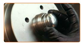
Trate da superfície onde a jante da roda entra em contacto com o tambor de travão. Use massa de cobre.
