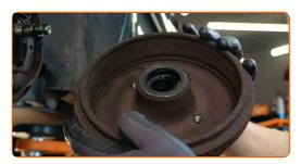
Limpe o local de montagem do rolamento de cubo. Use o spray de limpeza universal.
