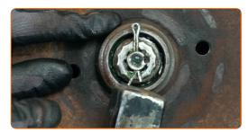
Desaparafuse a porca do cubo. Use uma chave soquete nº 24. Use uma chave de catraca.
