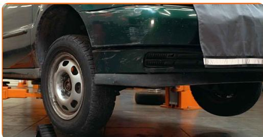
5 Desaperte os parafusos da roda.
