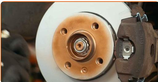
23 Limpe a superfície do disco de travão. Utilize um produto de limpeza para travões.
