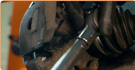
22 Trate a superfície onde o disco de travão entra em contacto com o aro da roda. Use massa de cobre.
