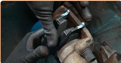
21 Instale a pinça do travão e fixe-o. Use HEX n.º H6. Use uma chave de torque. Aperte-o para o torque de 25 Nm.
