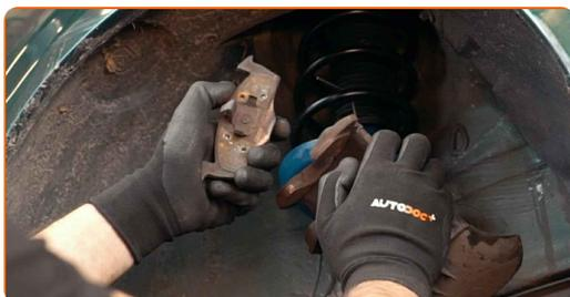
17 Limpe a braçadeira da pinça de travão de sujidade e poeira. Use uma escova metálica. Utilize um produto de limpeza para travões.
