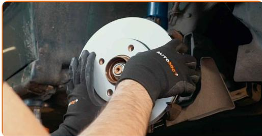
15 Aperte a fixação do disco de travão. Use Torx T27. Use uma chave de torque. Aperte-o para o torque de 9 Nm.
