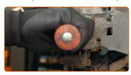
Limpe os elementos de fixação da pinça de travão. Use uma escova metálica. Use spray WD-40.
