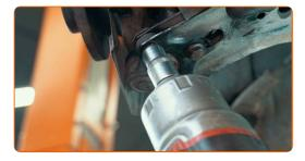
Instale o parafuso de fixação.
