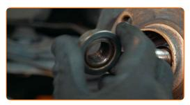
Limpe os fixadores que conectam as colunas de suspensão às mangas de eixo. Limpe o elemento de fixação que conecta o terminal de direção à manga de eixo. Use uma escova metálica. Use spray WD-40.
