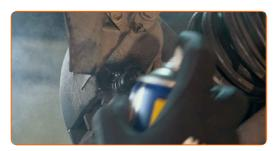
Desaparafuse a fixação de pinça de travão. Use HEX n.º H6. Use uma chave de catraca.
