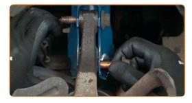
Limpe os fixadores que conectam a rótula de suspensão ao braço da suspensão. Use uma escova metálica. Use 21 spray WD-40.
