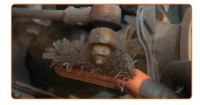
Desenrosque a extremidade da porca de fixação da manga de eixo. Use uma chave soquete nº 19. Use uma chave de catraca.
