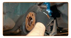
Desaperte o fixador que liga o eixo de transmissão ao cubo de roda. Use uma chave soquete nº 30. Use uma chave de catraca.
