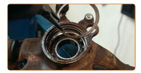
Limpe o local de montagem do rolamento de cubo. Use uma escova metálica. Use spray WD-40.
