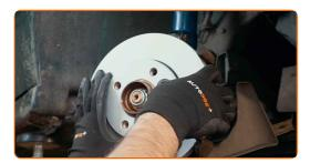
Aperte a fixação do disco de travão. Use Torx T27. Use uma chave de torque. Aperte-o para o torque de 9 Nm.
