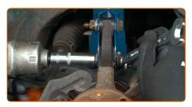
Remova o parafuso de fixação. 20
