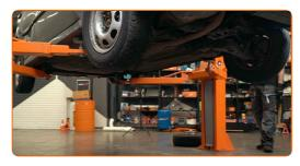
6 Desaperte os parafusos da roda.
