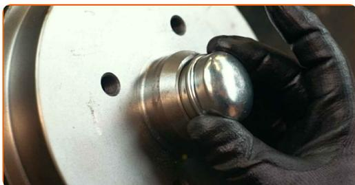
**38** Limpe o local de montagem do aro do pneu. Use uma escova metálica.
