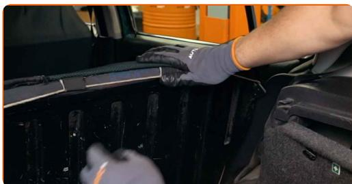
6 Desaperte os fixadores do painel de acabamento plástico lateral. Use Torx T20. Use uma chave soquete nº 7. Use uma chave de catraca.
