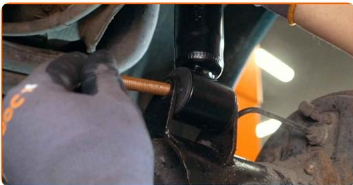
42 Apoie o eixo de torção da suspensão traseira. Use um macaco hidráulico de caixa de transmissão.
