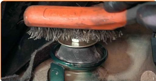
10 Desaparafuse o fixador superior do dispositivo amortecedor. Use uma chave combinada nº 16. Utilize a chave para amortecedor DDNº5,2. Use uma chave de catraca.
