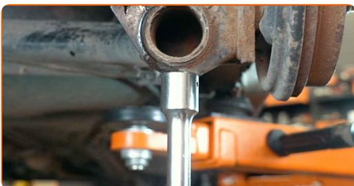
43 Aperte os fixadores inferiores do dispositivo amortecedor. Use uma chave combinada nº 17. Use uma chave soquete nº 17. Use uma chave de torque. Aperte-o para o torque de 55 Nm.
