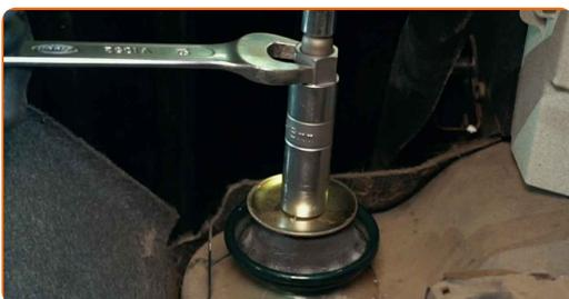
11 Desaparafuse o fixador superior do dispositivo amortecedor. Use uma chave combinada nº 17. Utilize a chave para amortecedor DDNº5,2. Use uma chave de catraca.
