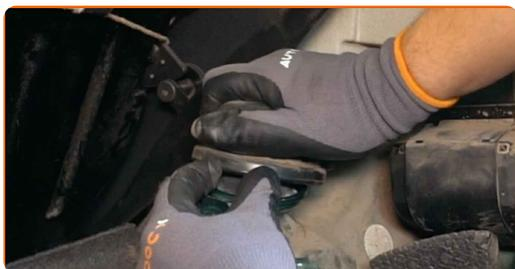
9 Limpe o fixador superior do suporte do dispositivo amortecedor. Use uma escova metálica. Use spray WD-40.
