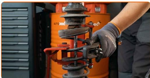
25 Trate a haste da coluna do amortecedor. Use uma escova metálica. Use spray WD-40.
