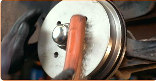
**36** Trate a superfície onde a jante da roda entra em contacto com o tambor de travão. Use massa de cobre.
