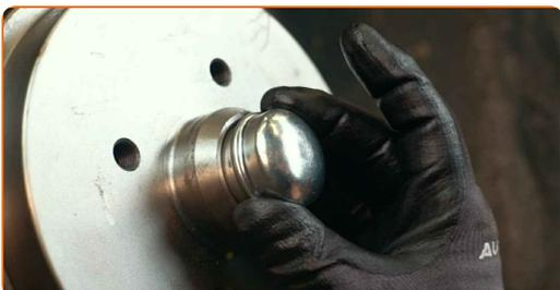
**35** Limpe o local de montagem do aro do pneu. Use uma escova metálica.
