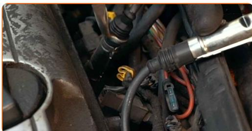
**Substituição: vela de ignição – VW Polo 6N1. Conselho da AUTODOC:**
