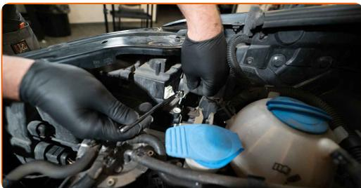
**3** Desencaixe o suporte da lâmpada girando-o cerca de 30°. Retire o suporte do local de montagem no farol.
