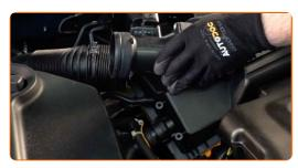
Levante levemente a tampa da caixa do filtro de ar.
