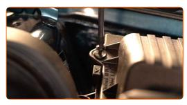
Desencaixe a braçadeira da mangueira da entrada de ar. Use alicates de bomba de água.
