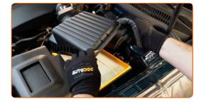
Remova o elemento de filtro a partir da caixa do filtro.
