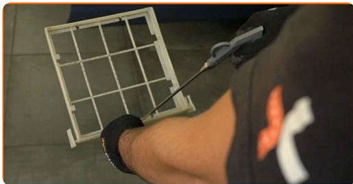
**7** Insira um novo elemento de filtro na caixa do filtro. Certifique-se de que a borda do filtro encaixa-se perfeitamente na caixa.
