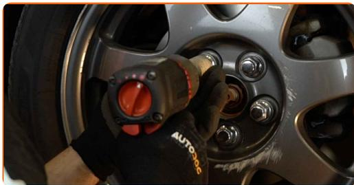
**30** Baixar o carro e trabalhar em ordem transversal, apertar os parafusos das rodas. Use uma chave de torque. Aperte-o para o torque de 103 Nm.
