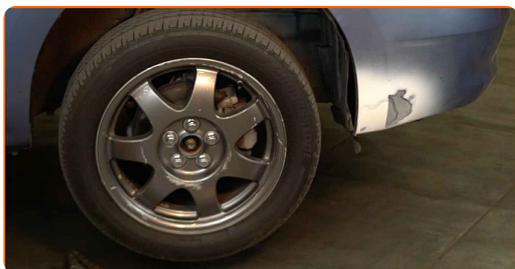
**5** Desaperte os parafusos da roda.
