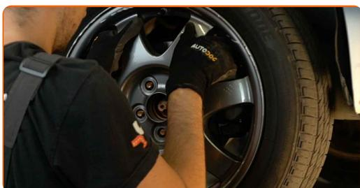
**29** Aperte os parafusos da roda. Use o soquete de impacto para roda #21.
