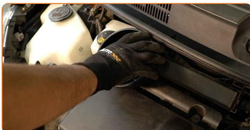
**21** Despeje o óleo no motor através do gargalo de enchimento de óleo. Quantidade necessária de óleo: 4.7 l.
