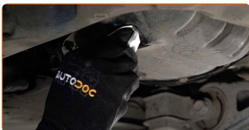
**16** Aparafuse o novo bujão de drenagem e aperte-o. Use uma chave soquete nº 14. Use uma chave de torque. Aperte-o para o torque de 27 Nm.
