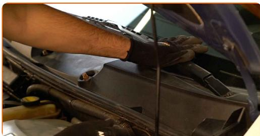
**29** Aperte os fixadores dos braços do limpa vidros. Use uma chave soquete nº 14. Use uma chave de torque. Aperte-o para o torque de 21 Nm.
