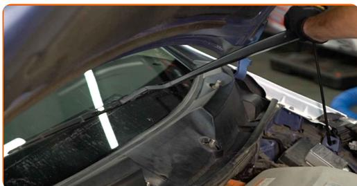
**5** Remova as tampas dos braços do limpa-vidros. Use uma ferramenta de remoção de clipe.
