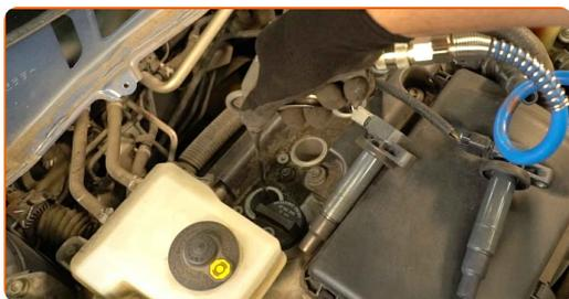
**15** Desaperte as velas de ignição. Use o soquete da vela de ignição #16. Use uma chave de catraca.
